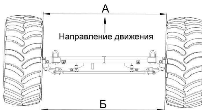
Рисунок 2.39 – Схема регулировки сходимости колес-
